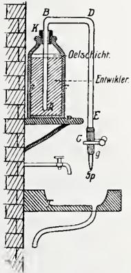
förmiges Rohr in die Mensur zum Abmessen abgelassen werden kann. — Die beifolgende Zeichnung erläutert dies. P ist ein, an der Wand befestigtes Postament, auf welchem über dem Waschtroge T eine Literflasche F erhöht angebracht ist. In dieser Flasche befindet sich, fast bis auf den Boden reichend, das heberförmige Glasrohr A B D E, welches bei K durch einen Kork geht.
